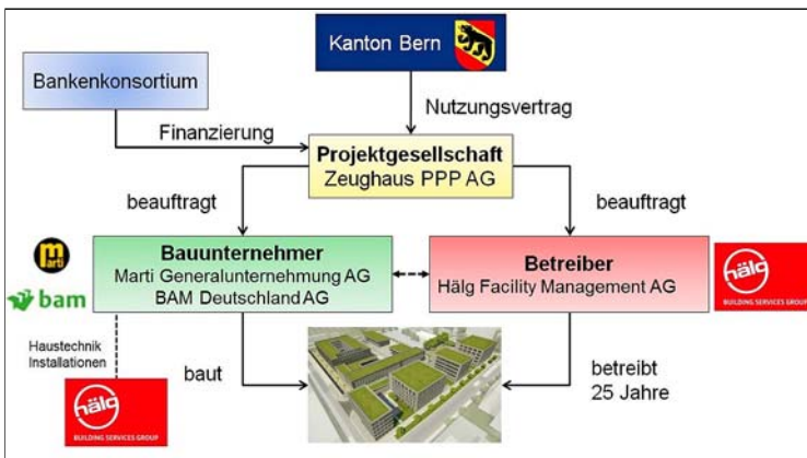
Abb. 2: Funktionsweise eines PPP-Projekts (PPP = Public Private Partnership, öffentlich private Partnerschaft), Beispiel Verwaltungszentrum Neumatt in Burgdorf.
